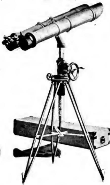
5. Doppelfernrohr mit 72facher Vergrößerung
