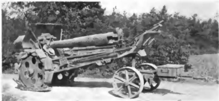
4. Langer Mörser (Krupp), gefedert. Fahrstellung.
